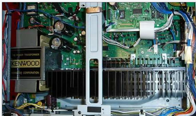
Der Kühlkörper ist zwar hochwertig ausgeführt, aber etwas klein
