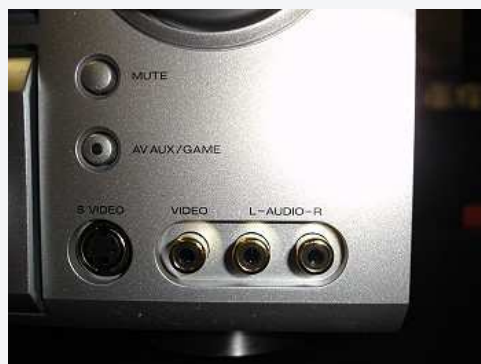
Front AV-Eingang mit S-Video-Beschaltung
